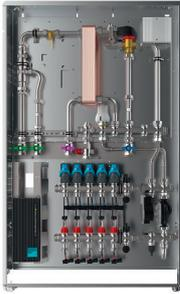
Die Wohnungsstation WS17-Smart dient der Warmwasserversorgung und zusätzlich der Versorgung und Regelung von Flächenheizungen mit Festwertregler 20-50 °C mit integrierter Pumpe.
