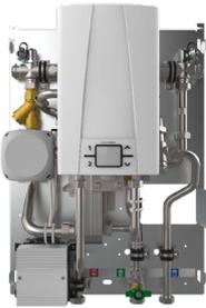
Die WS-GTA-Hybrid1-HT Gasthermenaustauschstation ist für den Austausch von Kombi-Gasthermen in Bestandsbauten gedacht. Durch die fast identische Anordnung der Trinkwasseranschlüsse an der Station, ist ein Austausch und der Neuanschluss durch hochwertige, flexible Anschlusschläuche und weiterem Zubehör leicht und schnell realisierbar.
